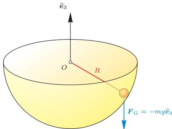
*Das sphärische Pendel kann man sich als eine Punktmasse vorstellen, die zu einem Aufhängepunkt (Ursprung  $O$ ) den konstanten Abstand  $R$  besitzt. Das Pendel kann unter dem Einfluss der Schwerkraft schwingen.*
