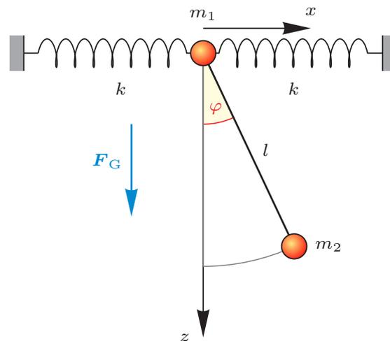
Die Massen  $m_1$  und  $m_2$  sind durch einen Stab der Länge  $l$  verbunden. Während  $m_1$  über zwei Federn mit Federkonstanten  $k$  an den Wänden befestigt ist, kann  $m_2$  an  $m_1$  unter dem Einfluss der Gravitationskraft  $\mathbf{F}_G$  schwingen.
